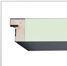
Skrzydło stalowe z wzmocnieniem drewnianym i wypełnione wełną mineralną
